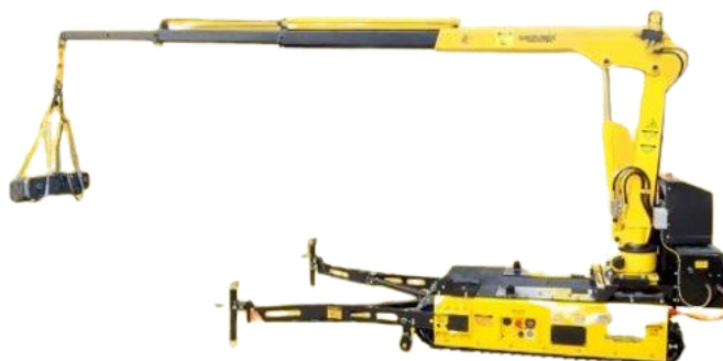
Mini crawler crane
